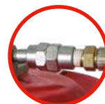
CONEXIÓN GIRATORIA DE MANGUERA A ENGRASADOR PARA EVITAR QUE LA MANGUERA SE TUERZA
