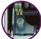
BOTÓN DE SEGURIDAD QUE LIBERA EL MECANISMO
